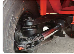
Trục lái sử dụng động cơ đốt trong, được đúc nguyên khối
